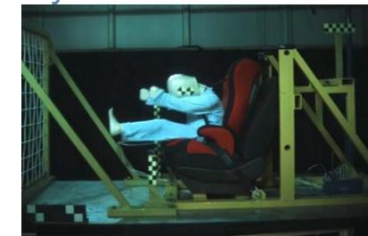
Динамические испытания комплектной ДУС на имитаторе в условиях фронтального столкновения и удара сзади.
